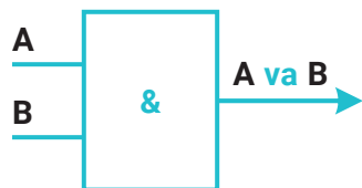
1-rasm. "VA" mantiqiy elementi
